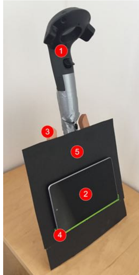
Abbildung 5.6: Bild des Proxy -Objekts (1 – HTC Vive Controller, 2 – Tablet, 3 – Staffelei, 4 – Halterung für Tablet, 5 – Abdeckung für Staffelei)
