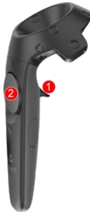
Abbildung 4.6: Ansicht des Controllers (1 – Button, 2 – klickbares Touchpad).
