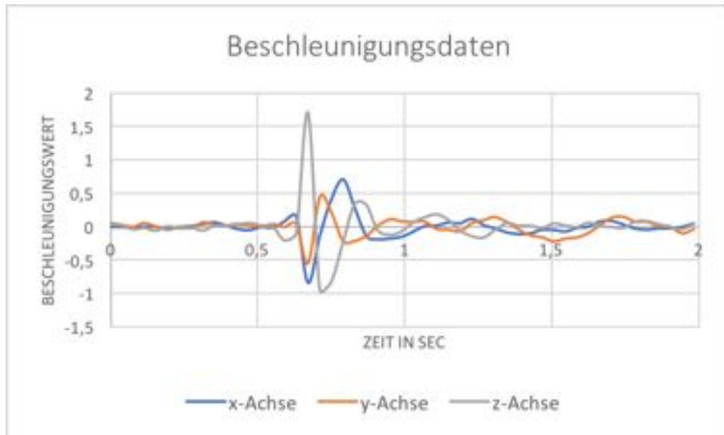
Abbildung 5.3: Verlauf der Beschleunigungsdaten der Smartwatch am linken Arm beim Tippen mit dem rechten Zeigefinger auf der linken Hand.
