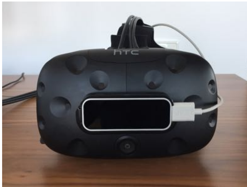
Abbildung 5.1: Bild der an der HTC Vive befestigten Leap Motion -Kamera.
