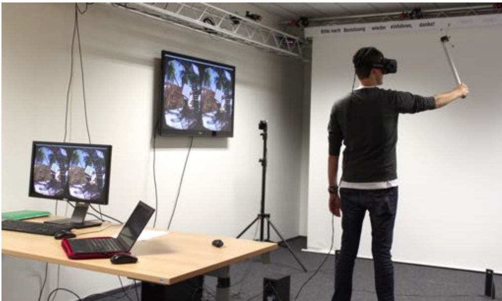
Abbildung 1.5: Bild eines Benutzers eines stabförmigen Proxy -Objekts, welches in der virtuellen Welt durch einen gehaltenen hölzernen Ast repräsentiert wird [25].
