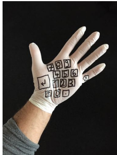
Abbildung 3.11: Handschuhprototyp mit dem finalen Layout des handflächenbasierten Interfaces.
