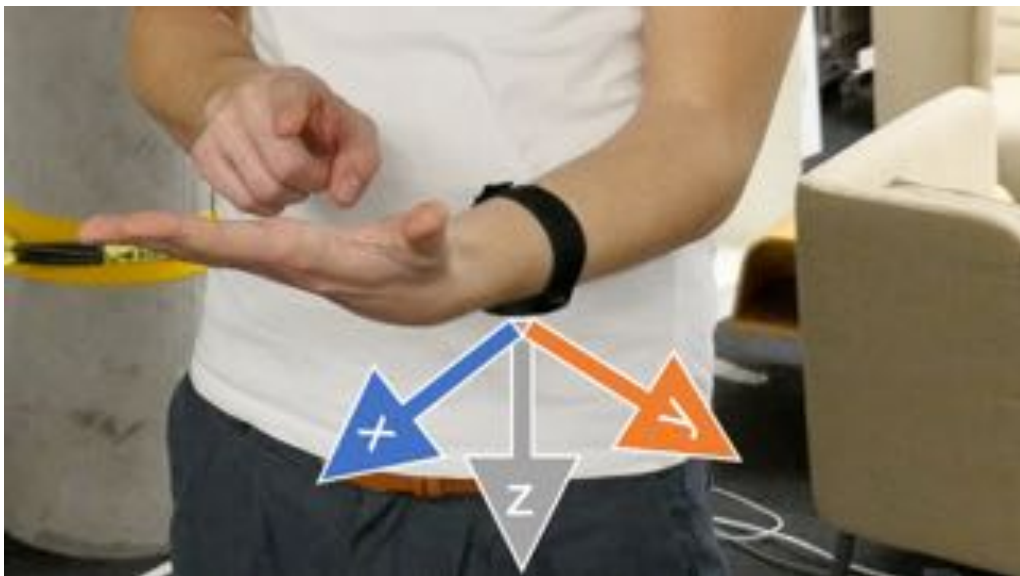
Abbildung 5.4: Ausrichtung der Achsen des Beschleunigungsmessers am Arm des Benutzers.
