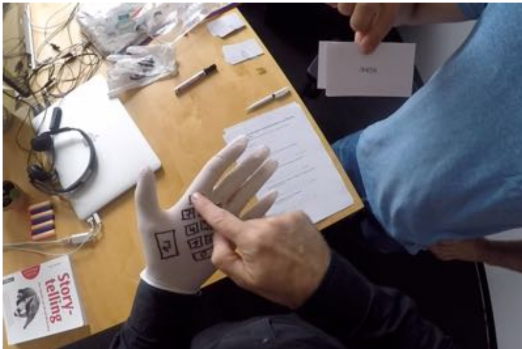
Abbildung 3.6: Bild aus Teilnehmersicht im Experiment der Vorstudie während der Eingabe einer negativen Ganzzahl mit dem Handschuhprototypen P1.1 .
