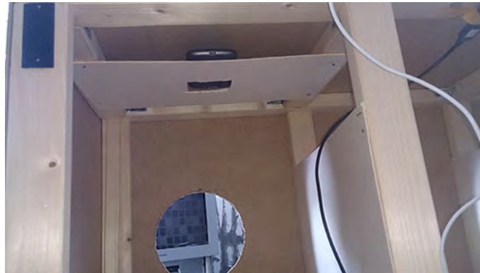
Abbildung 5.3: Zur Erkennung eines Einwurfs wurden Smartphones in den einzelnen Kammern eingesetzt.
