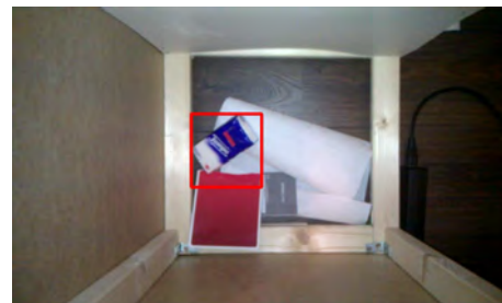
Abbildung 5.10: Mittels Template-Matching extrahiertes, neu hinzugefügtes, Objekt
